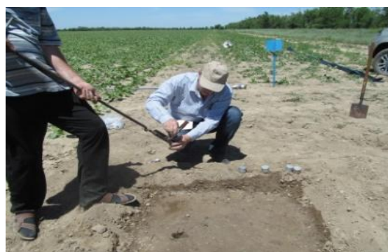
Рисунок 2 - Проведение полевого эксперимента и определение наименьшей влажности Figure 2 - Conducting a field experiment and determining the lowest humidity
