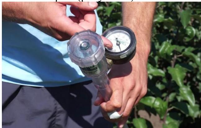
Рисунок 2 – Тензиометр
